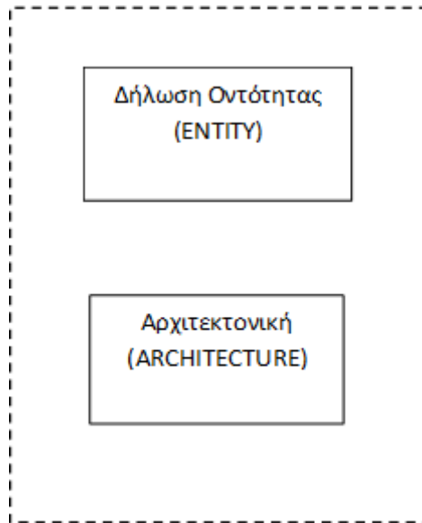
Σχήμα 1.5 Δομή κώδικα της γλώσσας VHDL
