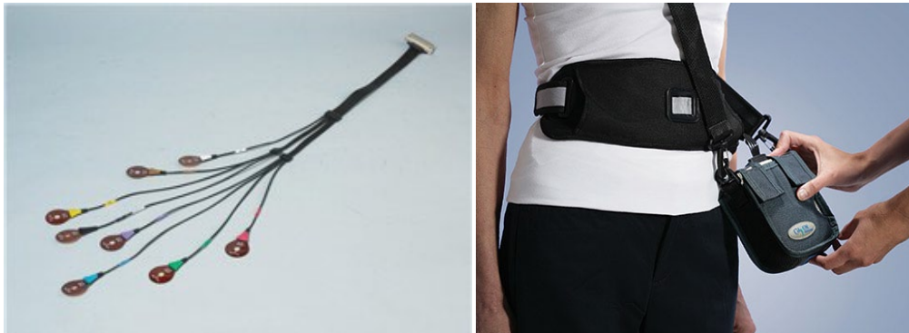
Εικόνα 6. Σύστημα αισθητήρων (αριστερά) και καταγραφέας δεδομένων ενσωματωμένος στην ειδική ζώνη (δεξιά).
