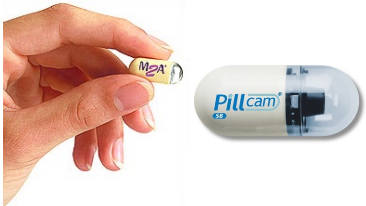
Εικόνα 4. Η πρώτη ασύρματη ενδοσκοπική κάψουλα M2A και Pillcam SB™.
