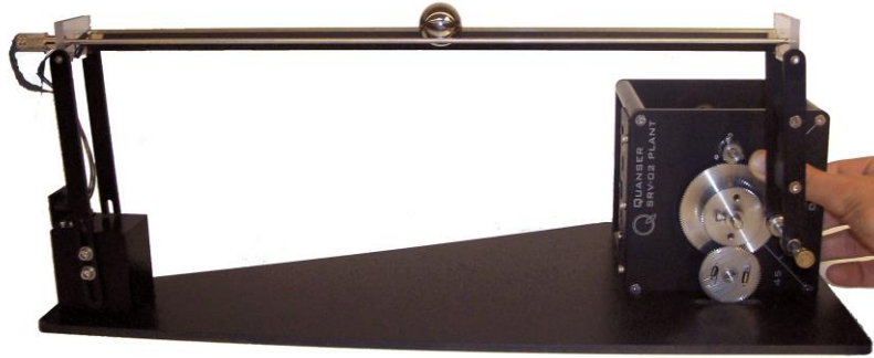
Εικόνα 1.7 Το BB01 βαθμονομείται όταν η μπάλα ισορροπεί στη δοκό, ενώ ο SRV02 είναι στις 0 μοίρες.
