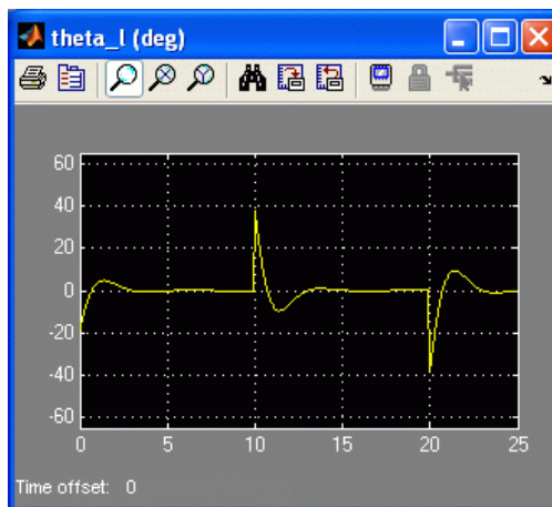
Εικόνα 3.3 Ανταπόκριση γωνίας σέρβο εξωτερικού βρόχου με χρήση ιδανικού PD ελεγκτή.
