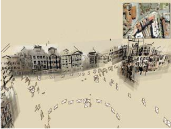
Εικόνα 1-2 Οι αλγόριθμοι ανασύστασης της χωρικής δομής από την κίνηση (structure from motion) μπορούν να ανακατασκευάσουν ένα τρισδιάστατο μοντέλο ενός μεγάλου πολύπλοκου σκηνικού από εκατοντάδες επικαλυπτόμενες φωτογραφίες.
