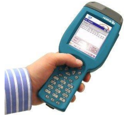
Σχήμα 5: Αναγνώστης RFID ετικέτας
