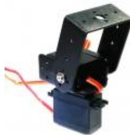
Εικόνα 19: Τοποθέτηση ενός σερβοκινητήρα στο πάνω μέρος του άλλου με τρόπο τέτοιο ώστε να σχηματίζουν συνδεσμολογία pan-tilt.
