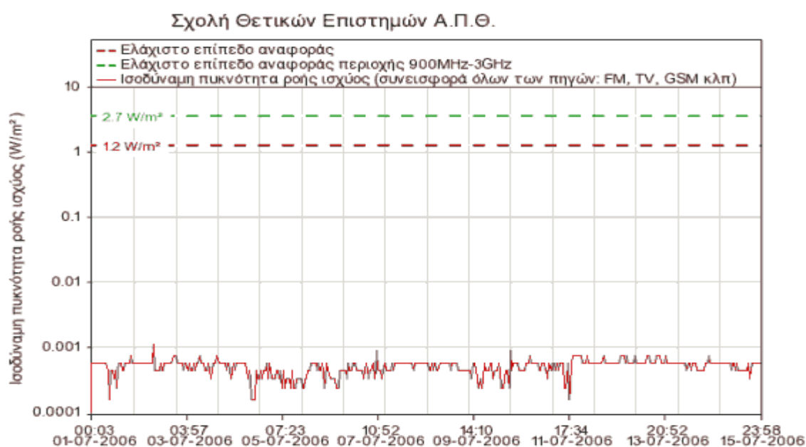
Σχήμα 3.1 Γράφημα της μέσης τιμής της πυκνότητας ροής ισχύος για τη συνολική περιοχή συχνοτήτων
