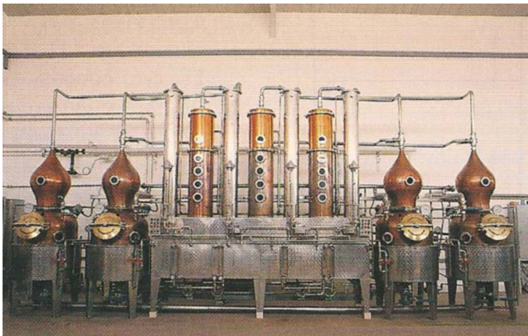
Εικ. 3.17: Αποστακτικό συγκρότημα παρασκευής τσίπουρου (Αποσταγματοποιία Κ. Λαζαρίδη - Δράμα)
