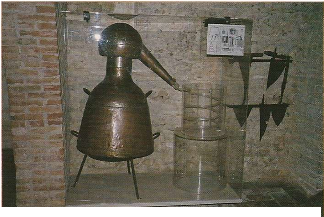
Εικ. 1.3: Άμβυκας απόσταξης στεμφύλων (17 ος αιώνας). Μουσείο Οίνου του ιδρύματος Λουνγκαρότι στο Τορτζιάνο (Ιταλία).
