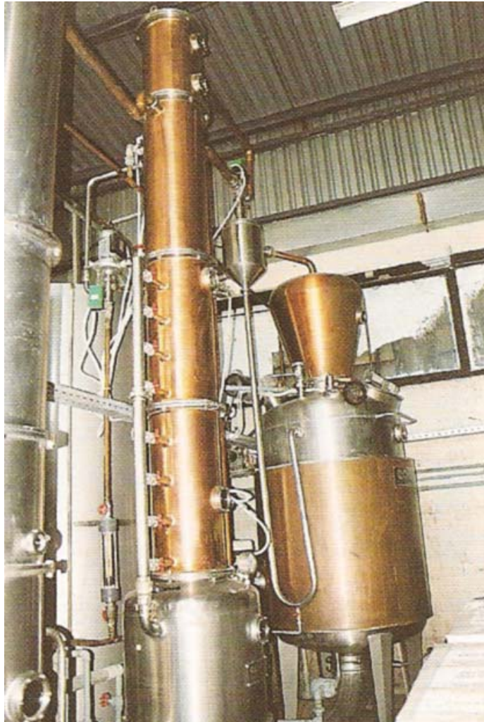
Εικ, 2.16: Σύγχρονο αποστακτικό συγκρότημα με «ελεύθερη» στήλη ανακαθορισμού (Αποσταγματοποιία Τσίλιλη - Τρίκαλα).
