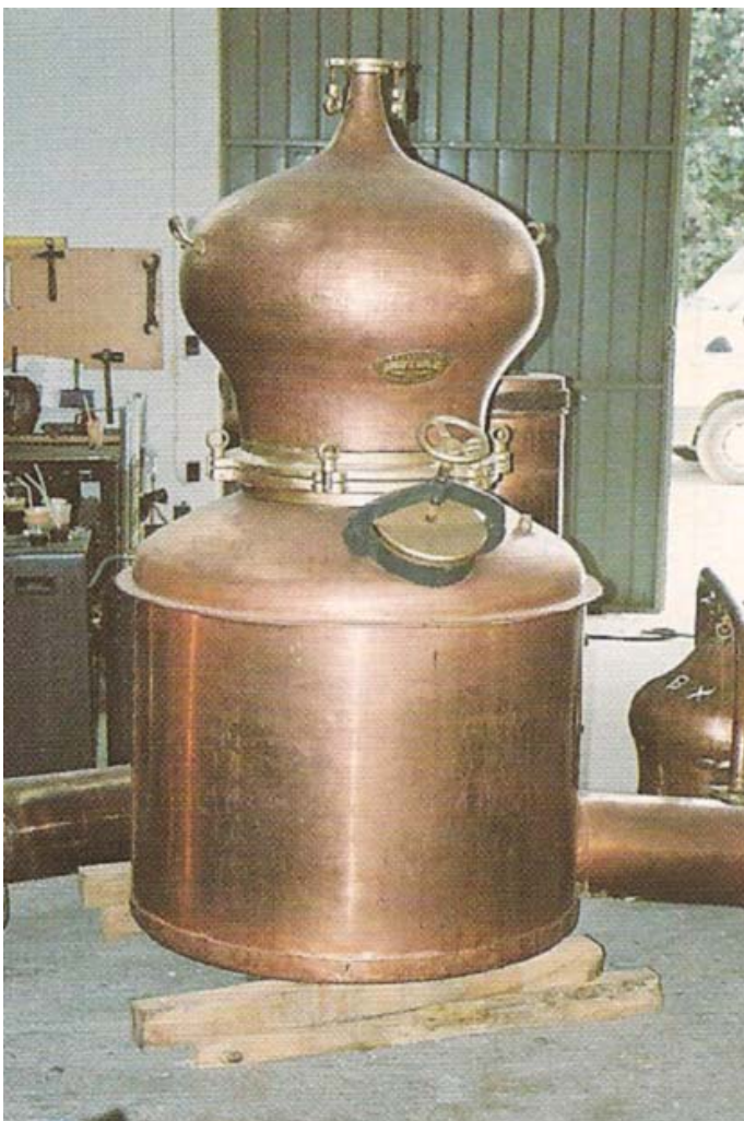
Εικ. 2.15: Αμβυκας απόσταξης στεμφύλων χωρητικότητας 1000 L πριν την εγκατάστασή του (Χαλκουργείο Ελευθεριάδη - Θεσσαλονίκη).
