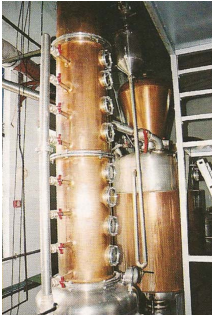
Εικ. 3.20: Στήλη απόσταξης τσίπουρου (Αποσταγματοποιία ΑΟΣ Τυρνάβου).
