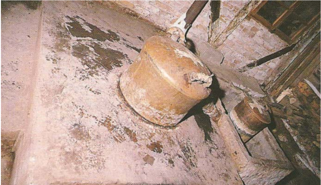
Εικ. 2.7: Φωτογραφία άμβυκα απόσταξης στεμφύλων - τύπου με βραχίονα.
