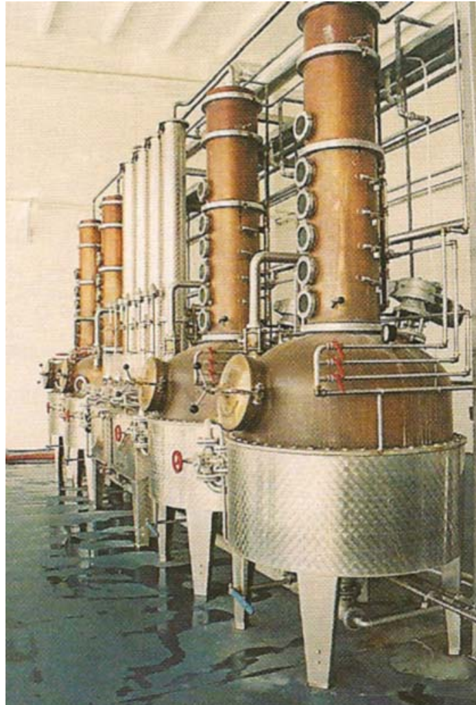
Εικ. 2.19: Αποστακτικές συσκευές στεμφύλων με ενσωματωμένες τις στήλες ανακαθορισμού στους λέβητες (Αποσταγματοποιία Ε. Τσάνταλη, Άγιος Παύλος Χαλκιδικής).
