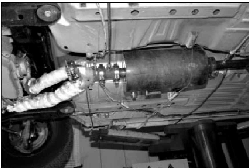
Σχ. 60 φωτογραφία καταλύτη ενός Ford Taurus με PCM
