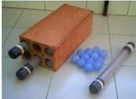
Σχ.6 Τούβλο με έξι οπές και PCM σε κάψουλες και σε σωλήνες
