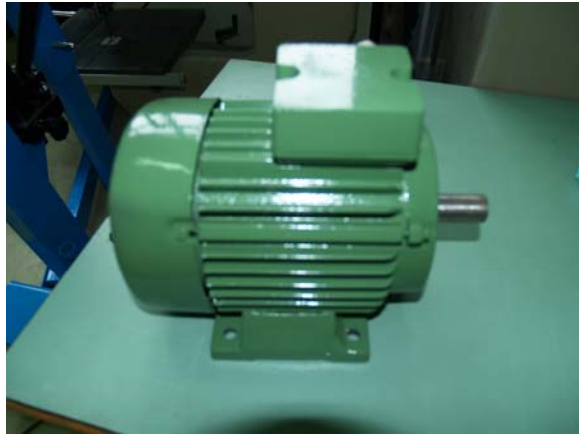
Φωτογραφία 1: Ηλεκτροκινητήρας 1500 rpm
