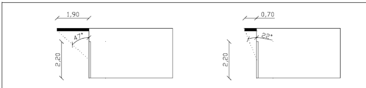
Σχήμα 8.9 : Γωνίες σκίασης βόρειας όψης από πρόβολο.
