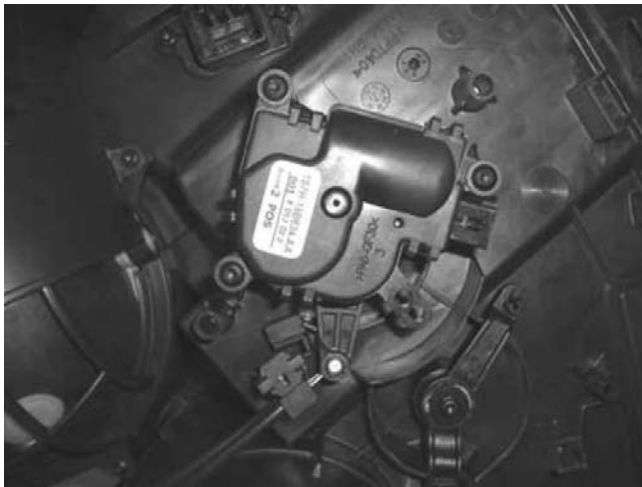
Σχήμα 1.29 Ηλεκτροκινητήρας ελέγχου με μειωτήρα στροφών
