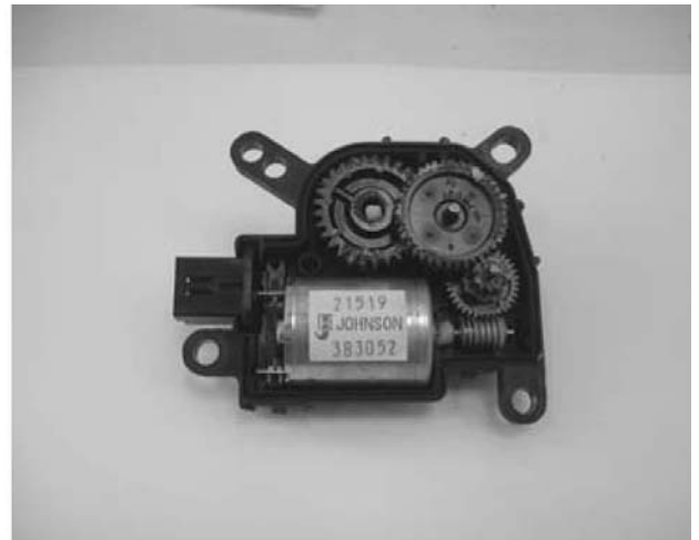
Σχήμα 1.29 Ηλεκτροκινητήρας ελέγχου με μειωτήρα στροφών
