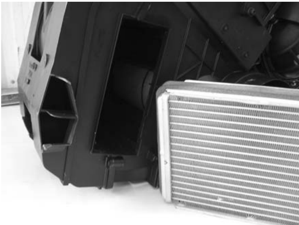
Σχήμα 2.40 Θέση του εξατμιστή μέσα στο συγκρότημα θέρμανσης
