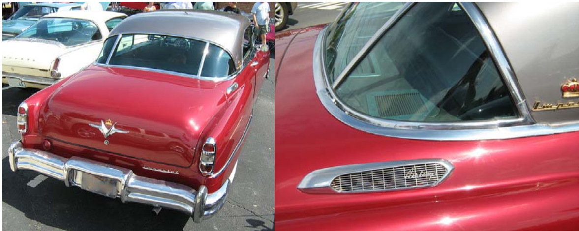
Chrysler Imperial του 1953 με το εργοστασιακής τοποθέτησης κλιματιστικό “AIRTEMP” στον χώρο αποσκευών (πηγή: Wikipedia)
