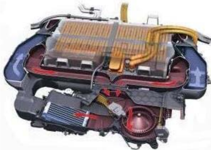
Σχήμα 1.37 Κανάλια ροής αέρα σε συστοιχία μπαταριών υψηλής τάσης. (πηγή: V.W.)
