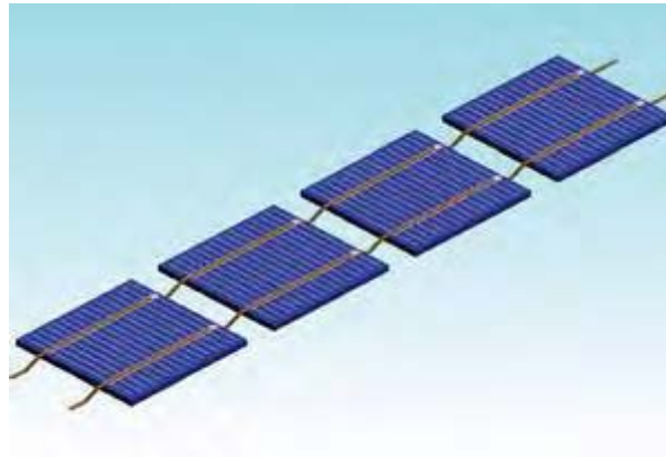
Ηλεκτρική σύνδεση ηλιακών στοιχείων
