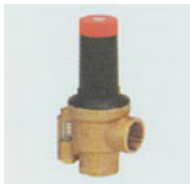
Εικόνα 10.11: ΒΑΛΒΙΔΑ ΔΙΑΦΟΡΙΚΗΣ ΠΙΕΣΗΣ Για περιορισμό της πίεσης σε κλειστά συστήματα θέρμανσης και προστασία του συστήματος από υδραυλική υπερπίεση
