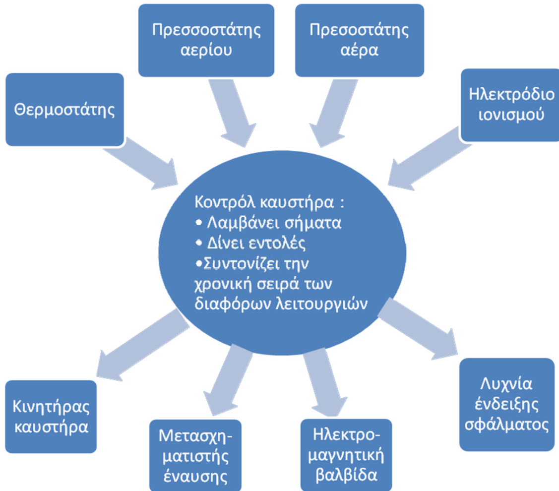
Σχήμα 5.36: ΤΟ ΚΟΝΤΡΟΛ ΠΑΡΑΚΟΛΟΥΘΗΣΗΣ ΤΟΥ ΚΑΥΣΤΗΡΑ ΜΕ ΤΙΣ ΣΥΝΔΕΣΕΙΣ ΤΟΥ
