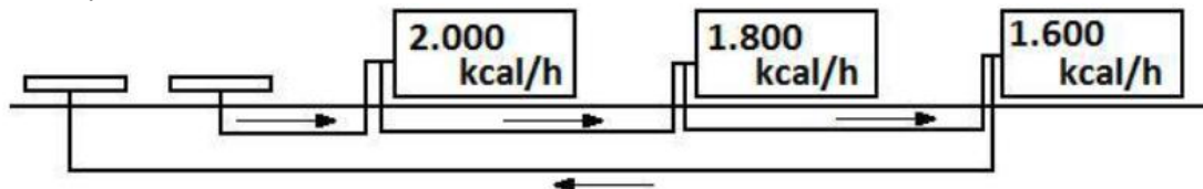
Σχήμα 8.12: ΣΤΟΙΧΕΙΩΔΕΣ ΚΥΚΛΩΜΑ ΠΑΡΑΔΕΙΓΜΑΤΟΣ
