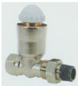
Εικόνα 10.13: ΔΙΑΚΟΠΤΗΣ ΘΕΡΜΑΝΤΙΚΟΥ ΣΩΜΑΤΟΣ ΜΕ ΑΥΤΟΜΑΤΟ ΡΥΘΜΙΣΤΗ ΠΙΕΣΗΣ Ανυπαρξία υπερθέρμανσης ή διακύμανσης θερμοκρασίας από την επιθυμητή σε όλα τα δωμάτια. Εξάλειψη της αλληλεξάρτησης της παροχής στα θερμαντικά σώματα, η παροχή είναι σταθερή σε όλα τα θερμαντικά σώματα ακόμα και όταν κάποιος χρήστης μεταβάλλει το σημείο ρύθμισης. Ακρίβεια στην τροφοδοσία όλων των θερμαντικών σωμάτων, με όσο ακριβώς νερό αυτά χρειάζονται, ανεξάρτητα με τις αλλαγές που συμβαίνουν στην εγκατάσταση.
