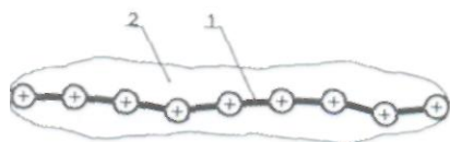
Σχήμα 4. Προετοιμασία θραυθέντων άκρων χυτοσιδήρου εξαρτήματος για την οξυγονοκόλληση εν θερμώ: 1 - ρωγμή, 2 - λοξοτόμηση.
