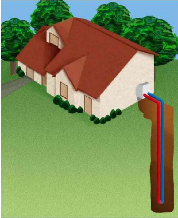
Εικόνα 16: Γεωθερμική αντλία θερμότητας με κατακόρυφο γεωθεναλλάκτη κλειστού κυκλώματος μιας γεώτρησης, για θέρμανση κατοικίας.
