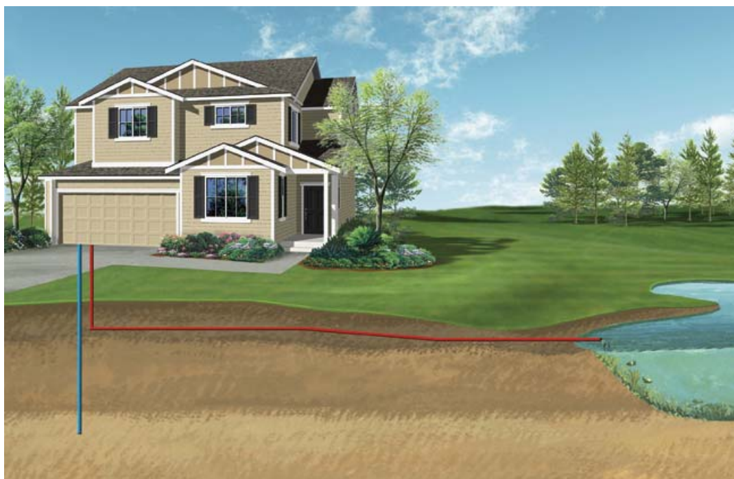
Εικόνα 5: Μεικτό σύστημα αβαθούς γεωθερμίας για θέρμανση κατοικίας. [15]
