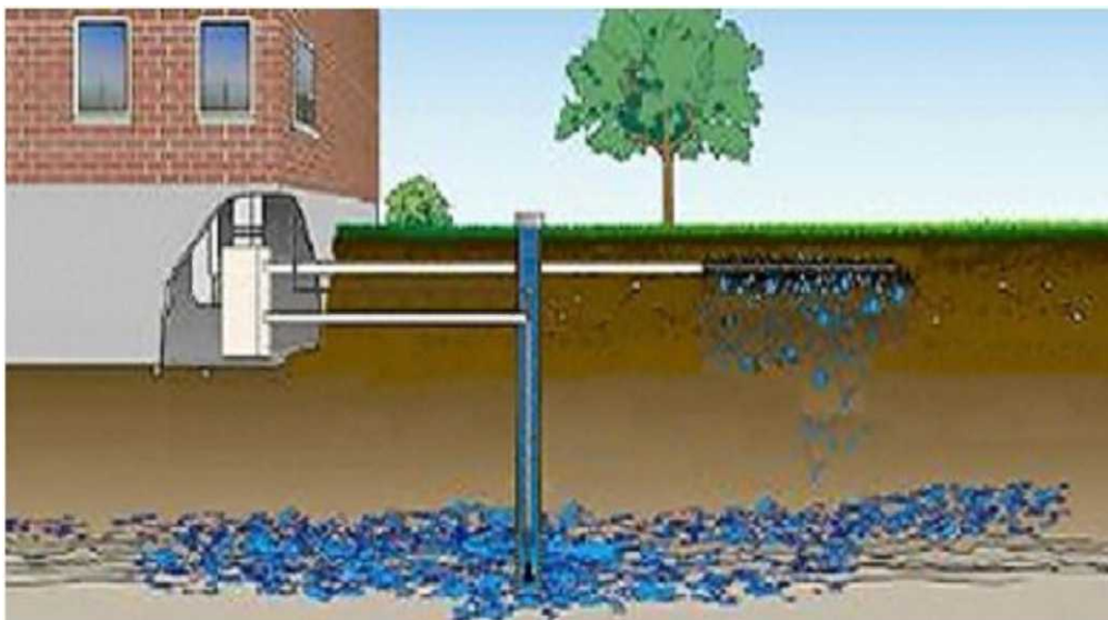
Υπόγεια Διάθεση του υπό απομάκρυνση νερού
