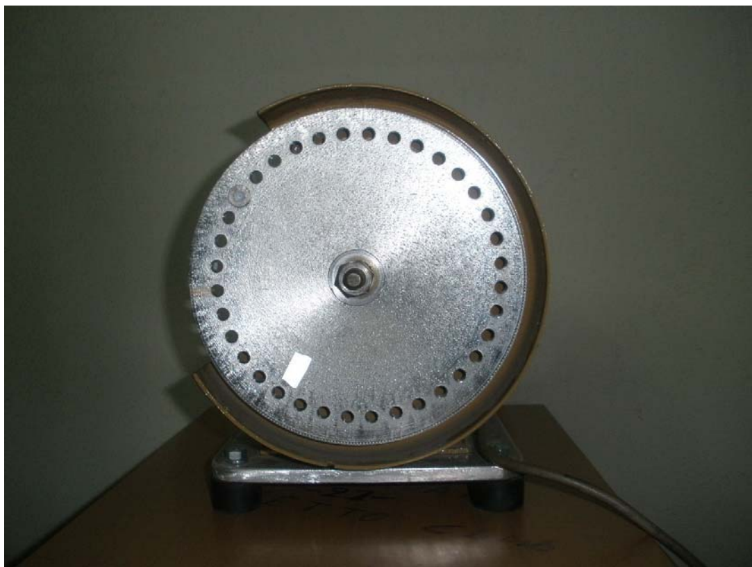
Εικ2 Ο δίσκος με τις 36 οπές όπου πάνω του τοποθετούνται οι μάζες ζυγοστάθμισης
