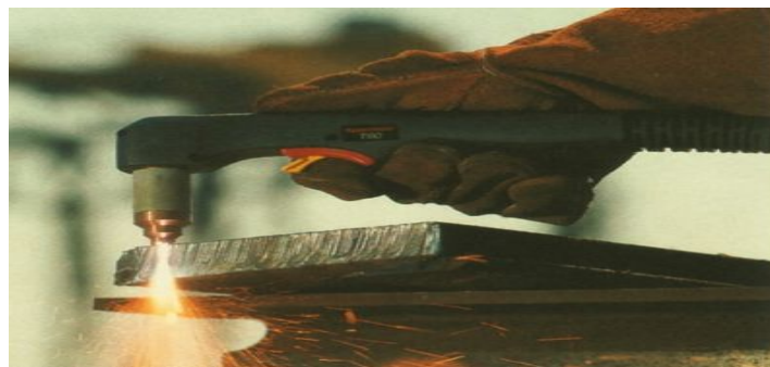
Εικόνα 18 : Κοπή με πλάσμα
