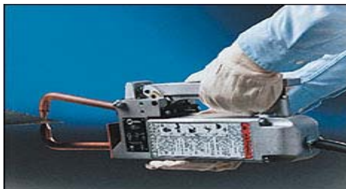
Εικόνα 51 : Συσσκευή ηλεκτροσυγκόλλησης με ηλεκτροπόντα
