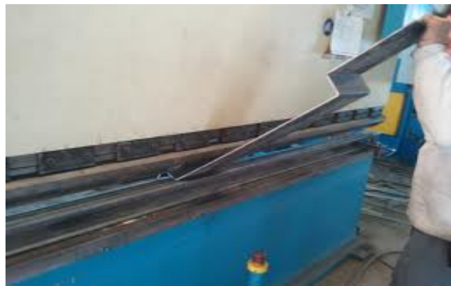
Εικόνα 22 : Επεξεργασία σε στραντζόπρεσα
