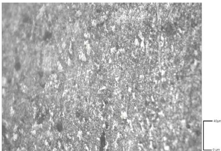
Εικ. 3.3.14 Φωτογραφία συγκόλλησης με τον αντικειμενικό φακό 50x θέση γ. Όπως προηγουμένως, αλλά το οπτικό πεδίο της φωτογραφίας έχει μετακινηθεί προς τα πάνω. Άρα το άνω άκρο της ρωγμής φαίνεται στο μέσον της κάτω πλευράς της φωτογραφίας.
