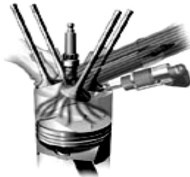
Εικόνα 4.15 – Λειτουργία του κινητήρα FSI υπό μεγάλα φορτία.
