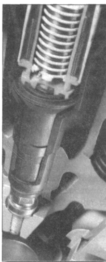
Εικόνα 3.17 – Στην πλήρως ηλεκτρονική ανάφλεξη ο πολλαπλασιαστής βρίσκεται ακριβώς πάνω από τον σπινθηριστή.
