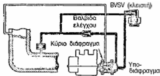
Εικόνα 5.54 – Άνοιγμα της πεταλούδας κάτω από τη θυρίδα προπορείας για θερμοκρασία ψυκτικού υγρού πάνω από 54 °C.
