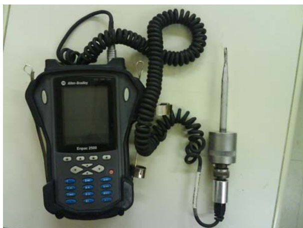
Εικόνα 3.22. Για την μέτρηση των κραδασμών της αντλίας χρησιμοποιούμε τον φορητό μετρητή ENPAC 2500 της εταιρίας ALLEN-BRADLEY
