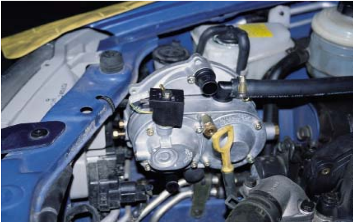
Εικόνα 3.8: Πνεύμονας και τοποθέτηση στο αυτοκίνητο ανάλογα με τη διάταξη του κινητήρα.
