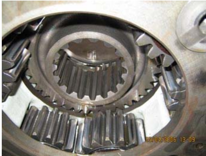
2.25 : Από την επισκευή πλανητικού συστήματος transmission.
