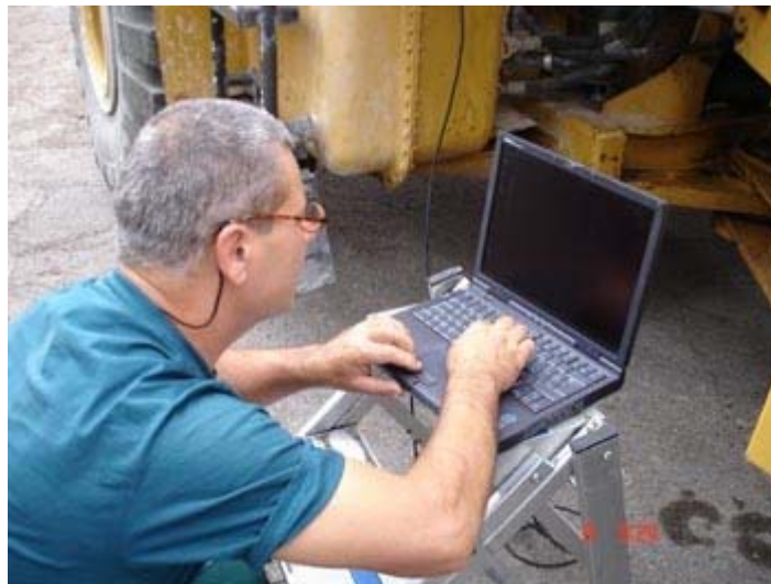
2.19 : Ηλεκτρονικός έλεγχος και προγραμματισμός κινητήρα.
