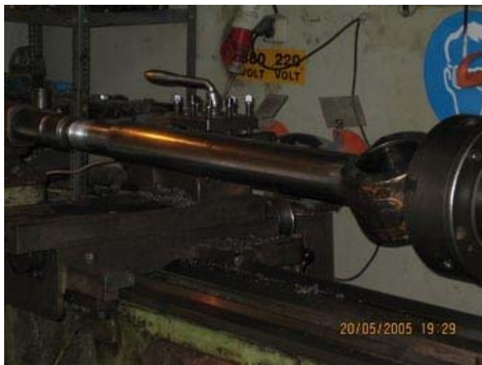
2.41 : Από τον έλεγχο στρέβλωσης και ευθυγράμμισης σε βάκτρο μπουκάλας.
