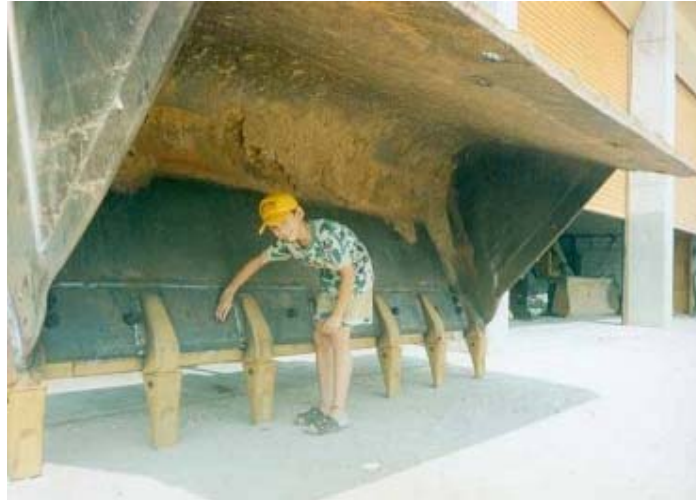
2.36 : Κάδος στον οποίο έχουν αντικατασταθεί τα φθαρμένα νύχια με καινούρια.
