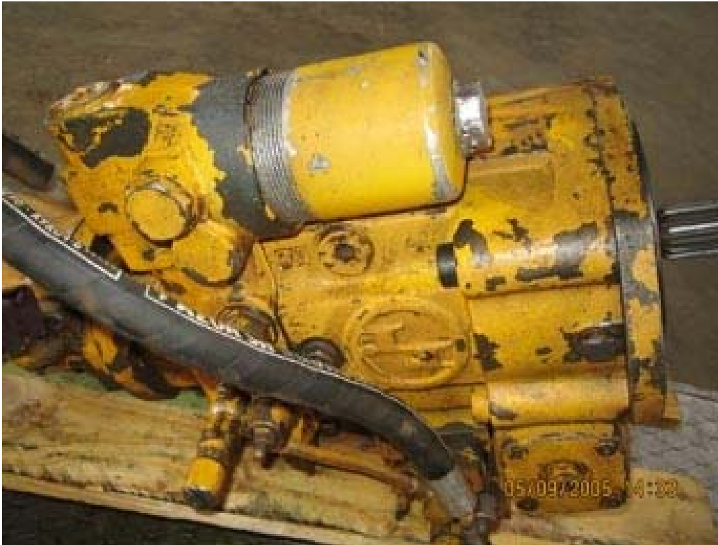
2.39 : Αντλία περιστροφής εκσκαφέα μετά από επισκευή.
