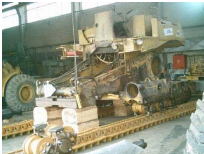
2.12 : Από τοποθέτηση ερπύστριας σε προωθητή.
