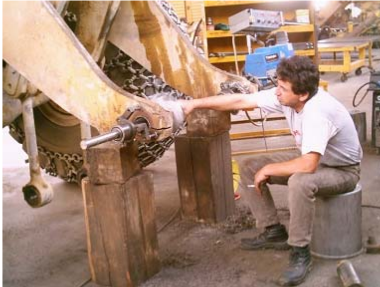
2.21 : Από την επιμετάλλωση με boring οπών στο πλαίσιο.
