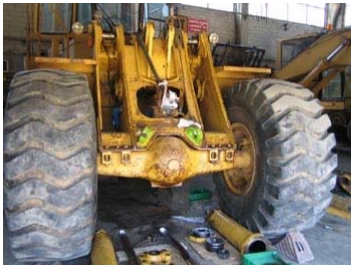
2.40 : Από την επισκευή υδραυλικών κυλίνδρων λαστιχοφόρου φορτωτή.
