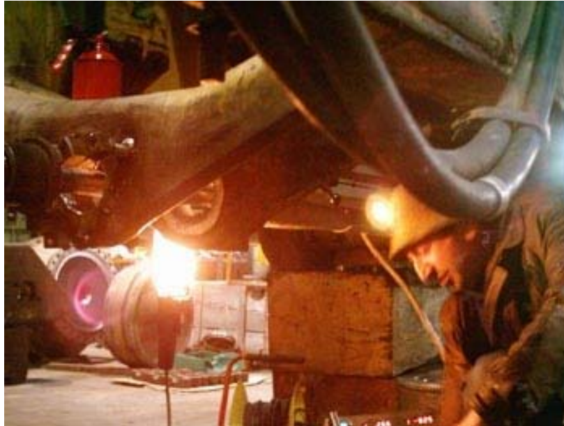
2.23 : Από την επιμετάλλωση και τορνάρισμα οπής συγκράτησης δοκαριού.
