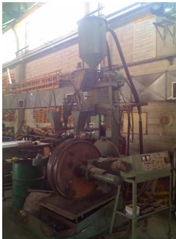
3.17 : Ειδικό εργαλείο στο οποίο γίνονται εργασίες επιμετάλλωσης εξωτερικά.
