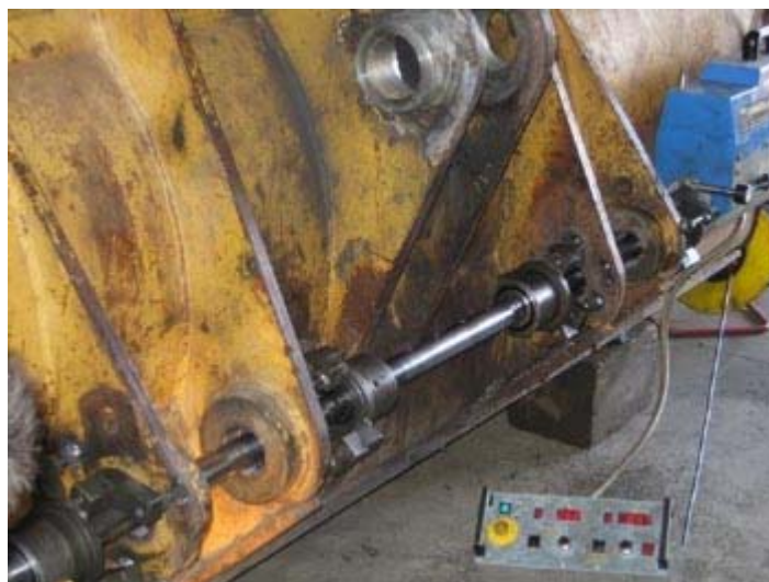
2.38 : Από επιμετάλλωση κουβά στο σημείο στήριξης.
