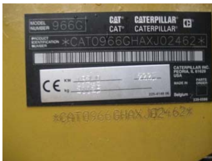
2.20 : Μεταλλική μικρή πινακίδα στο πλαίσιο της δομικής μηχανής που αναγράφει το serial number
