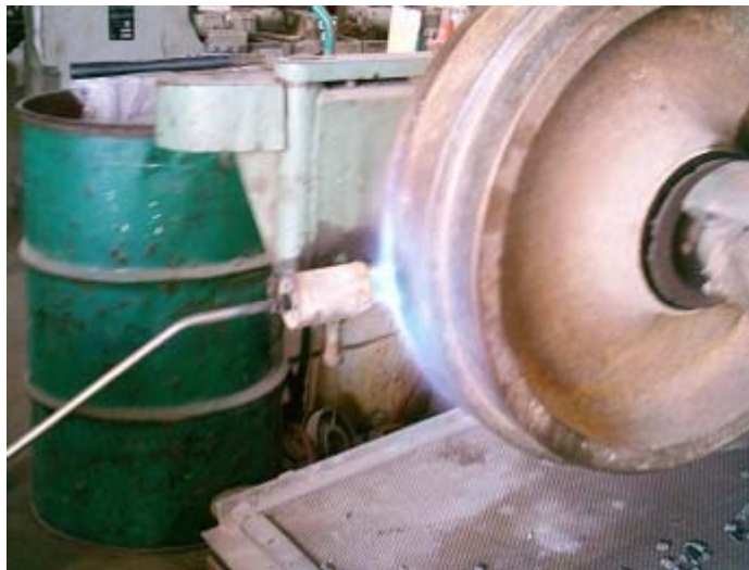
2.13 : Προετοιμασία αδρανή τροχού για επιμετάλλωση.
