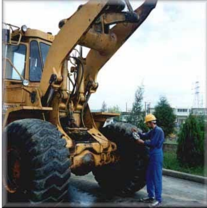
2.42 : Άποψη από τις μετρήσεις και τις ρυθμίσεις υδραυλικού συστήματος.
