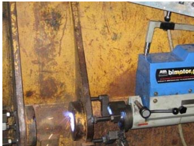
2.37 : Από επιμετάλλωση κουβά σε σημείο στήριξης.
