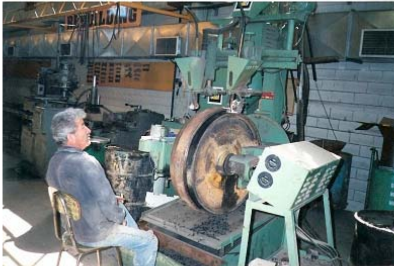
2.14 : Επιμετάλλωση αδρανή τροχού σε ειδικό μηχάνημα επιμετάλλωσης.
