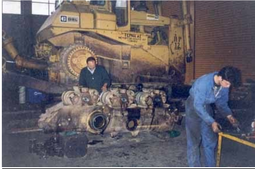
2.3 : Από την επισκευή πλαισίου στήριξης του συστήματος κυλίσεως.
