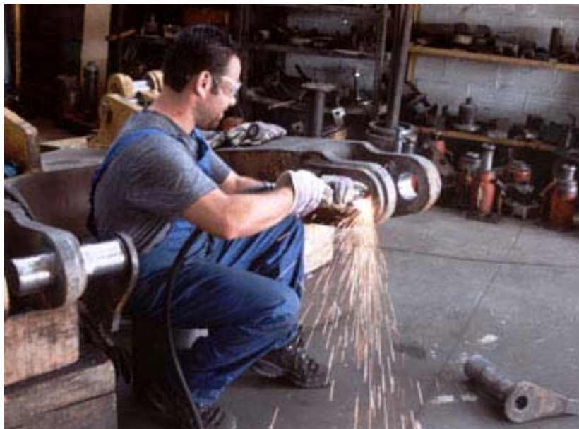
2.24 : Κατά την διάρκεια επισκευών τμήματος του πλαισίου.
