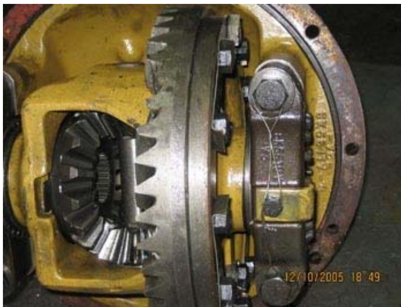
2.27 : Διαφορικό CAT 918 κατά τη επισκευή.
