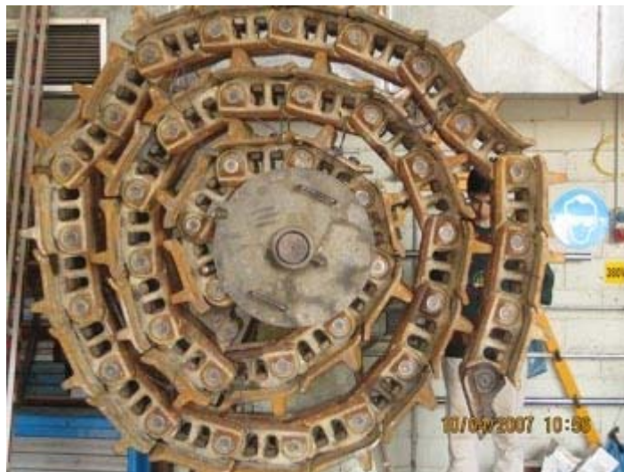
2.9 : Ερπύστρια τυλιγμένη στην ανέμη τυλίγματος ερπυστριών.
