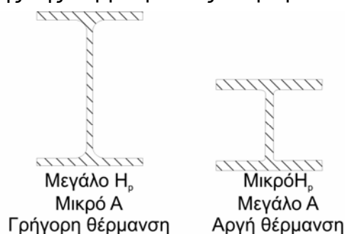
Σχήμα 1 Επίδραση λόγου H_p/A στη συμπεριφορά δομικών στοιχείων σε κατάσταση πυρκαγιάς
