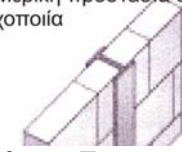
Σχήμα 7 Προστασία με ενσωμάτωση σε άλλα δομικά στοιχεία
