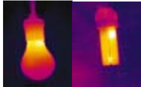
Εικόνα 7.1 : Θερμογράφημα λαμπτήρα πυρακτώσεως (αριστερά) και ηλεκτρονικού λαμπτήρα (δεξιά).
