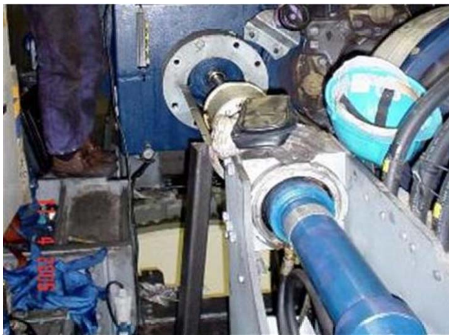
Υδραυλικό έμβολο στην έξοδο του σασμάν με το οποίο συνδέεται ο άξονας του pitch
