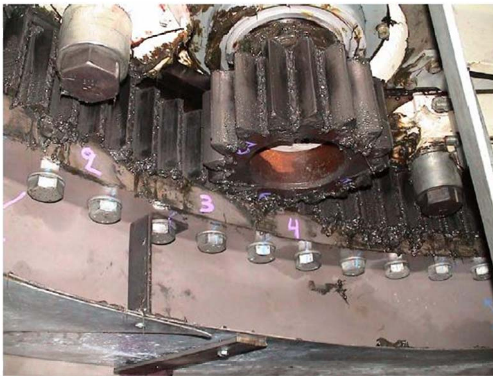
Γρανάξι ηλεκτροκινητήρα στην οδοντωτή στεφάνη της αιράκτου
