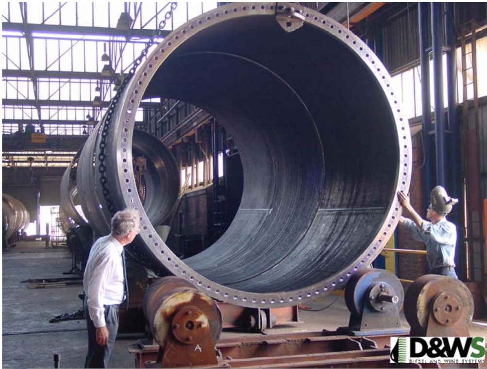
Συγκόληση τμημάτων χαλύβδινου πύργου
