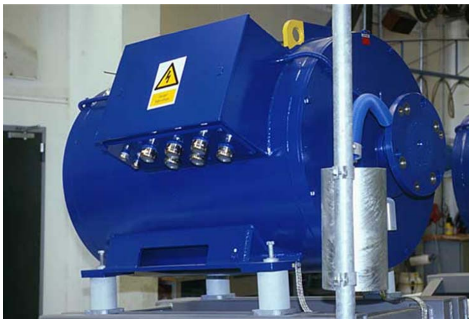
Ηλεκτρική γεννήτρια ανεμογεννήτριας
