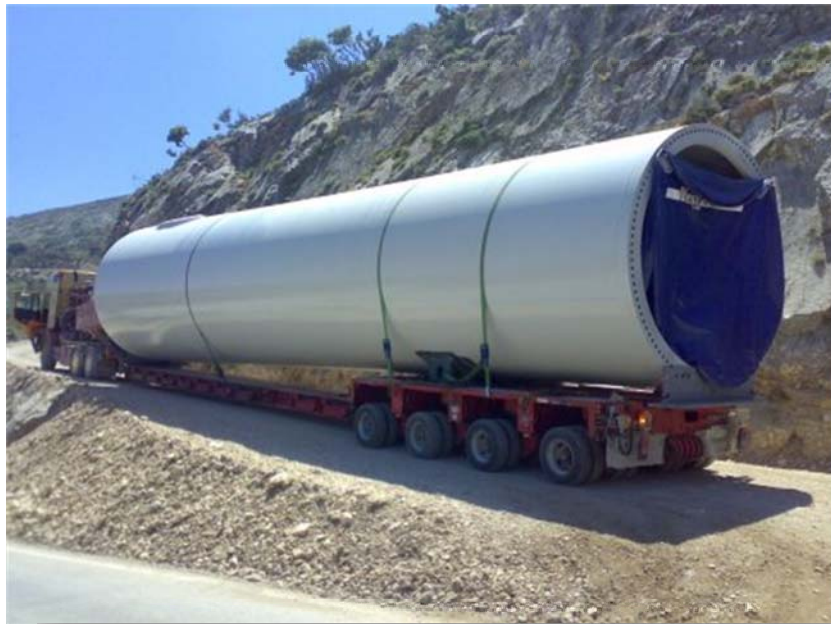
Μεταφορά τμήματος σωληνωτού πύργου μιας Α/Γ.
