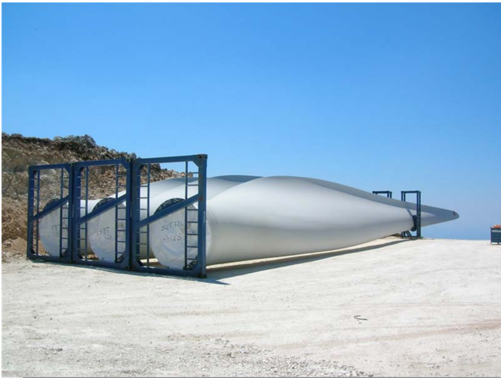
Πτερύγια ανεμογεννήτριας τοποθετημένα στα πλαίσια μεταφοράς τους.
