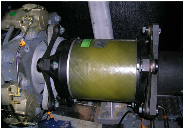
Ελαστικός σύνδεσμος που συνδέει τον άξονα του σασμάν με τον άξονα της γεννήτριας
