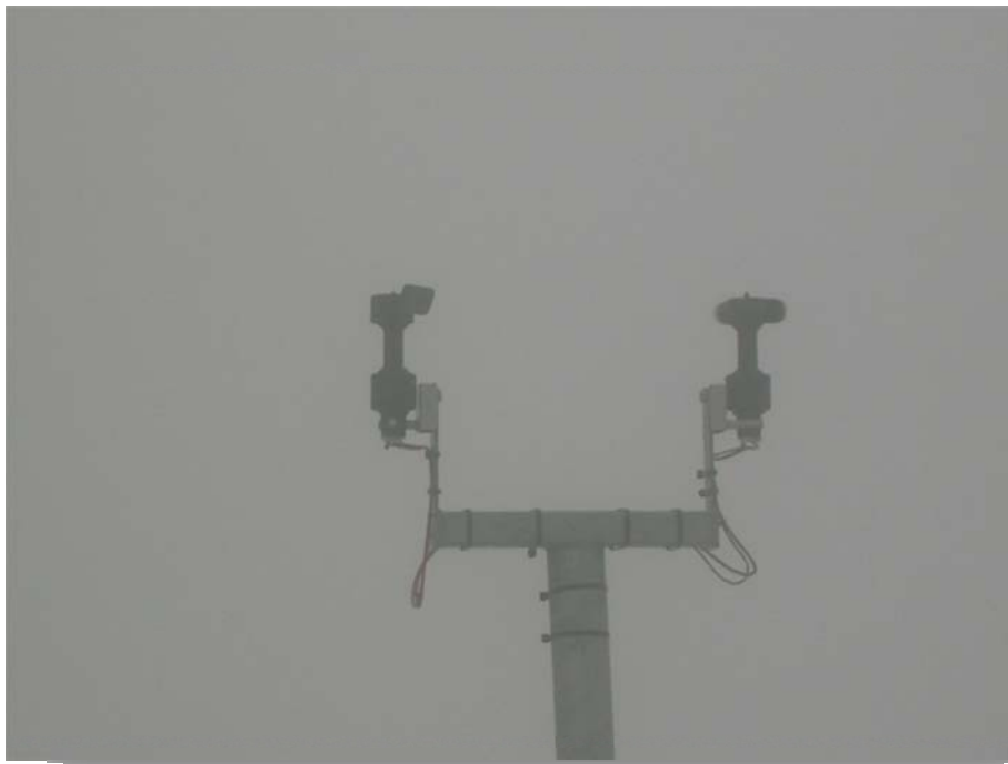
Ανεμοδείκτης και ανεμόμετρο συνδεδεμένα στην κορυφή της ατράκτου μιας Α/Γ.
