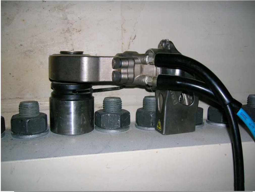
Κεφαλή για σύσφιξη περαστών κοκλιών μεταξύ δυο φλαντζών
