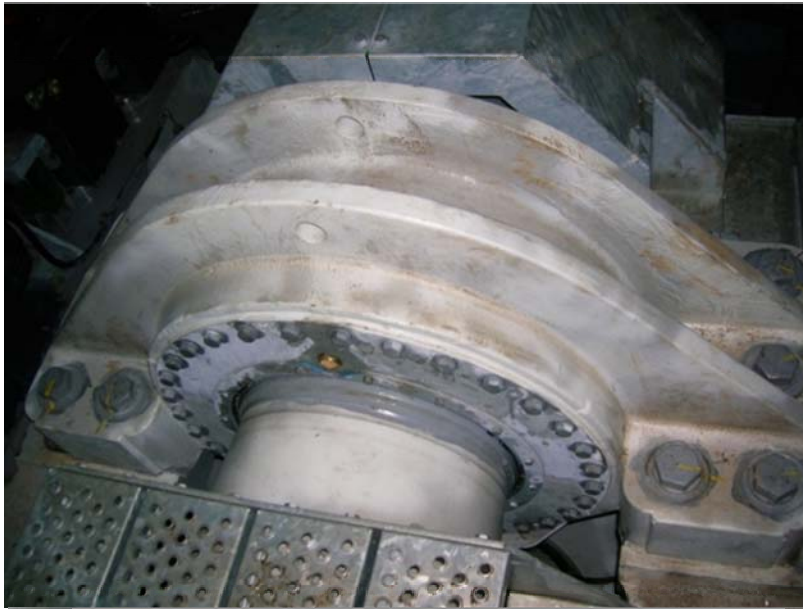
Έδραση άξονα χαμηλής ταχύτητας στην πλευρά του πολλαπλασιαστή στροφών
