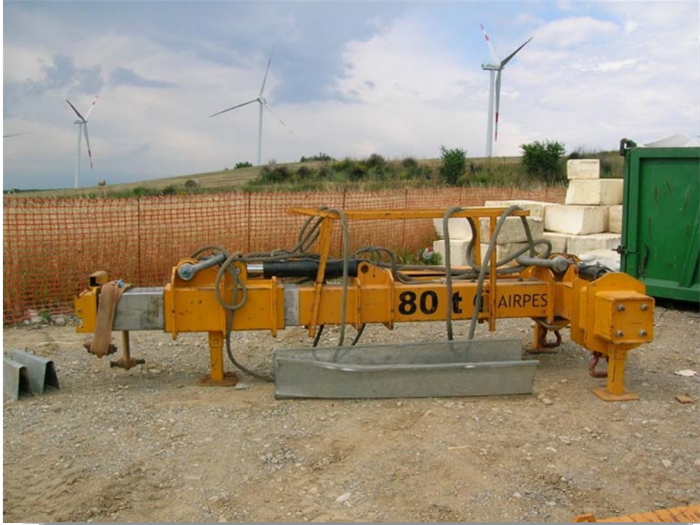
Ανυψωτική συσκευή άτρακτου που χρησιμοποιεί η εταιρεία Gamesa
