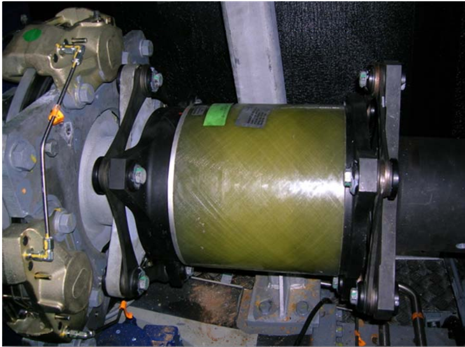
Άξονας υψηλής ταχύτητας στην έξοδο του πολλαπλασιαστή στροφών
