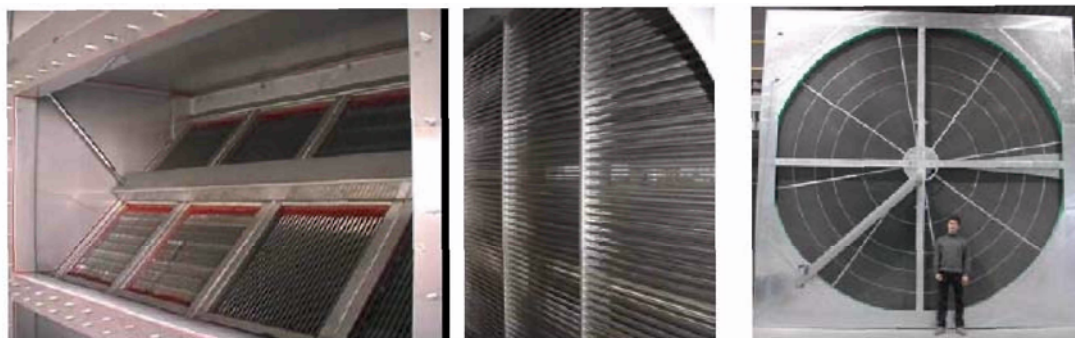
Αριστερά πλακοειδής εναλλάκτης θερμότητας αέρα/ αέρα, στο κέντρο σωληνωτός εναλλάκτης θερμότητας αέρα /νερού και δεξιά εναλλάκτης τύπου Rotary Wheel αέρα/ αέρα, παροχής 220.000\text{Nm}^3/\text{h} .
