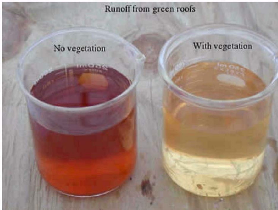
Εικόνα 66: Απορροή βρόχινου νερού. Αριστερά χωρίς την ύπαρξη βλάστησης στην ταράτσα, δεξιά, μετά από φιλτράρισμα του από το φυτεμένο δώμα [84]
