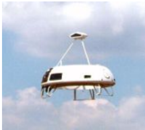
Sikorsky Cypher UAV τροφοδοτείται με UEL AR801 Wankel κινητήρα.
