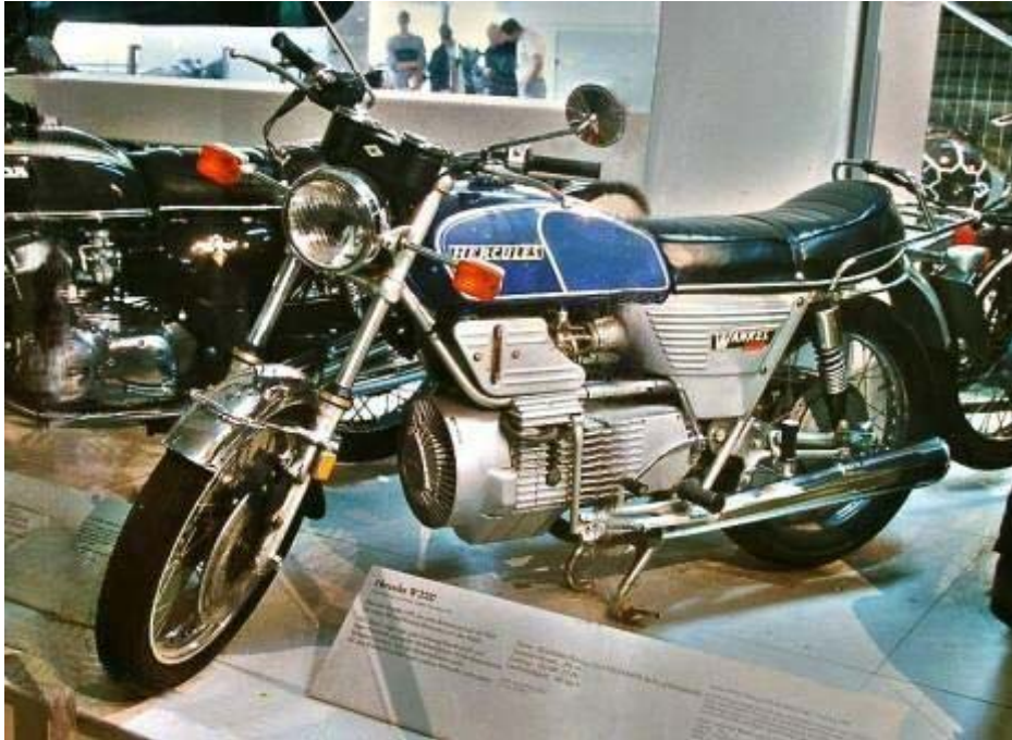
Hercules W 2000 με Wankel κινητήρα( KC 27 294 cc 27ps)
