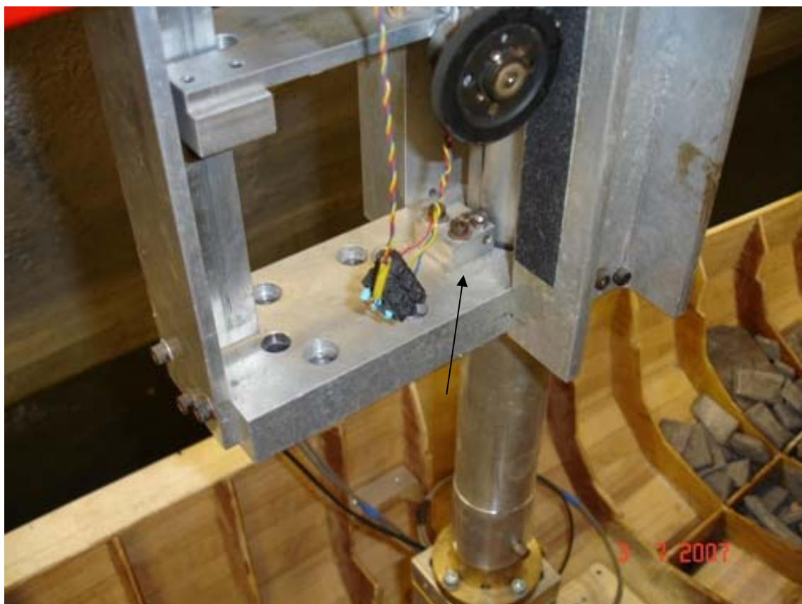
Εικόνα 4.1 Το έδρανο που κρατάει την δοκό σταθερή
