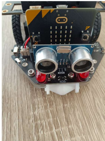
Εικόνα 22. Μέτρηση απόστασης μέσω υπερήχων.
