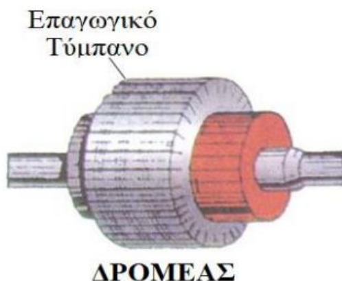
Εικόνα 2.31 Κινητό μέρος κινητήρα συνεχούς ρεύματος
