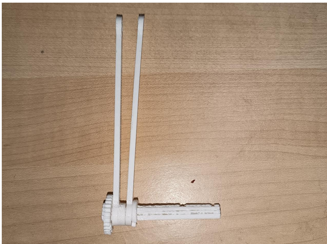
Εικόνα 37: Συναρμολόγηση ποδιών του ρομπότ - βήμα 3 έως 4
