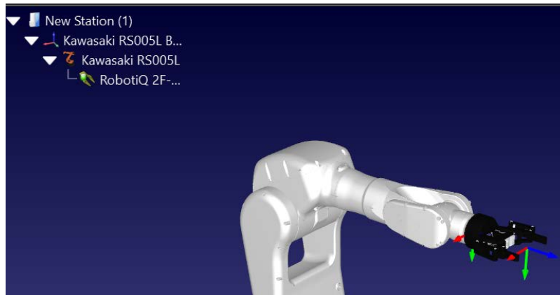
Εικόνα 82. Ενσωμάτωση αρπάγης στο ρομπότ
