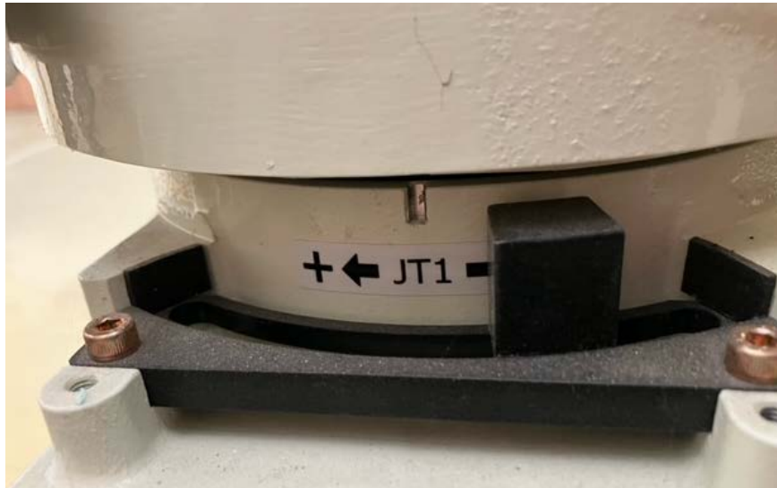
Εικόνα 8. Τερματικός μηχανικός διακόπτης του βραχίονα
