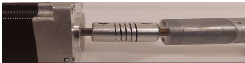
Εικόνα 14: Σύνδεση DC motor με Stepper motor
