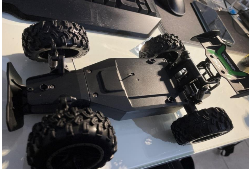
Σχήμα 12: Αφαίρεση καμπίνας του οχήματος
