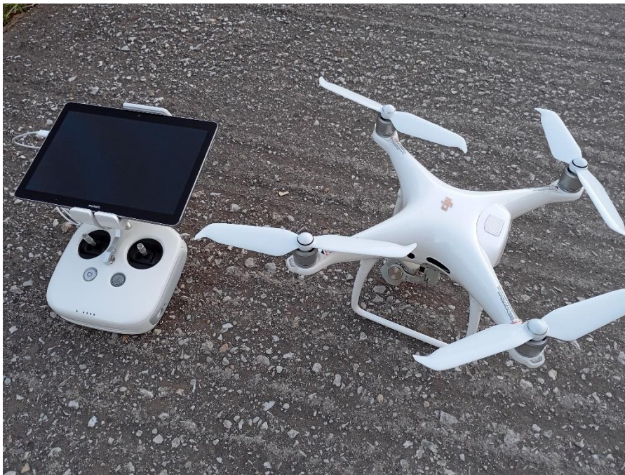
Εικόνα 5: Το UAV DJI Phantom 4 PRO V2.0
