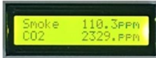
Σχήμα 41: Ένδειξη καπνού και διοξειδίου του άνθρακα
