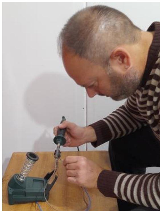
Εικόνα 21: Συγγόλιση καλωδίων με καλάι.
