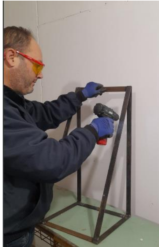
Εικόνα 7: Άνιγμα οπών στην βάση.
