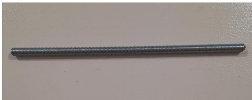
Εικόνα 20: Ολόπαση ντίζα διαμέτρο 8mm.
