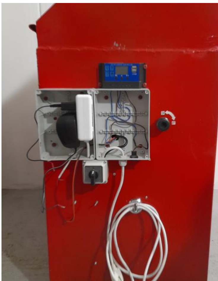
Εικόνα 22: Συνδεσμολογία πολίμπριζου και ρυθμιστή φόρτισης συσσωρευτή.
