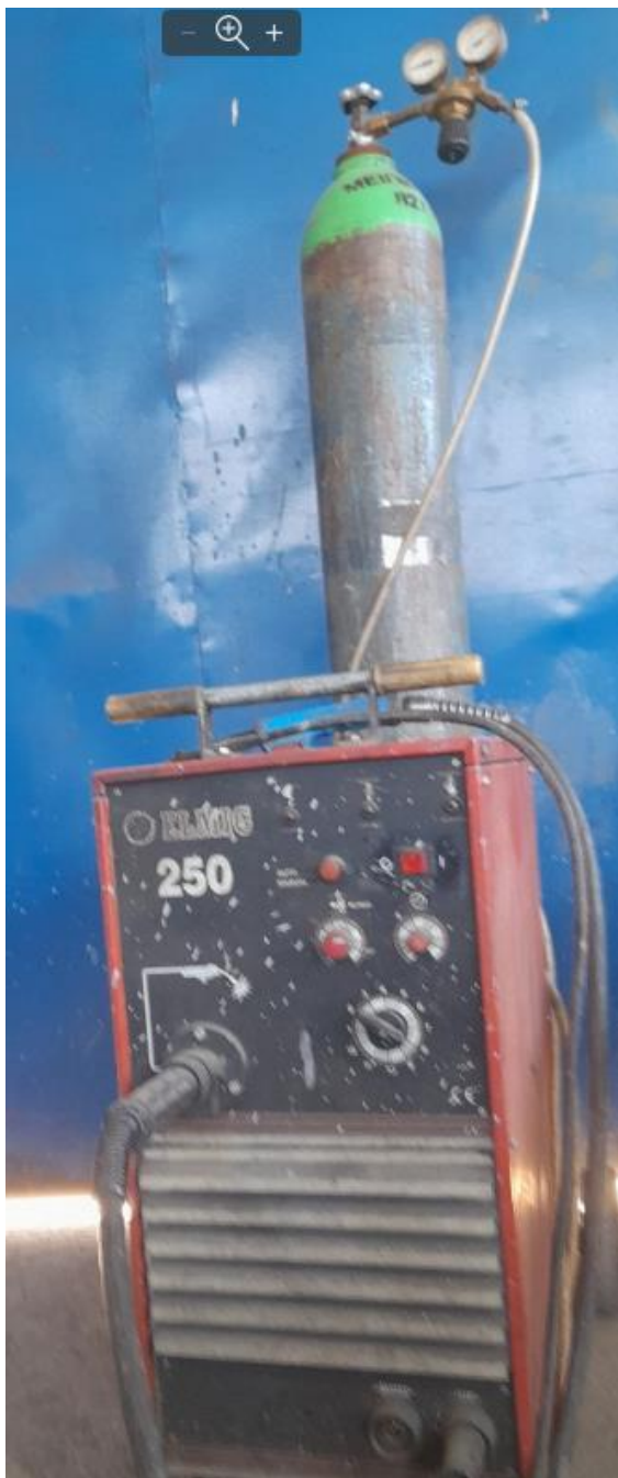
Εικόνα 4: Ηλεκτροσυγκόλληση με σύρμα και αδρανές αέριο.
