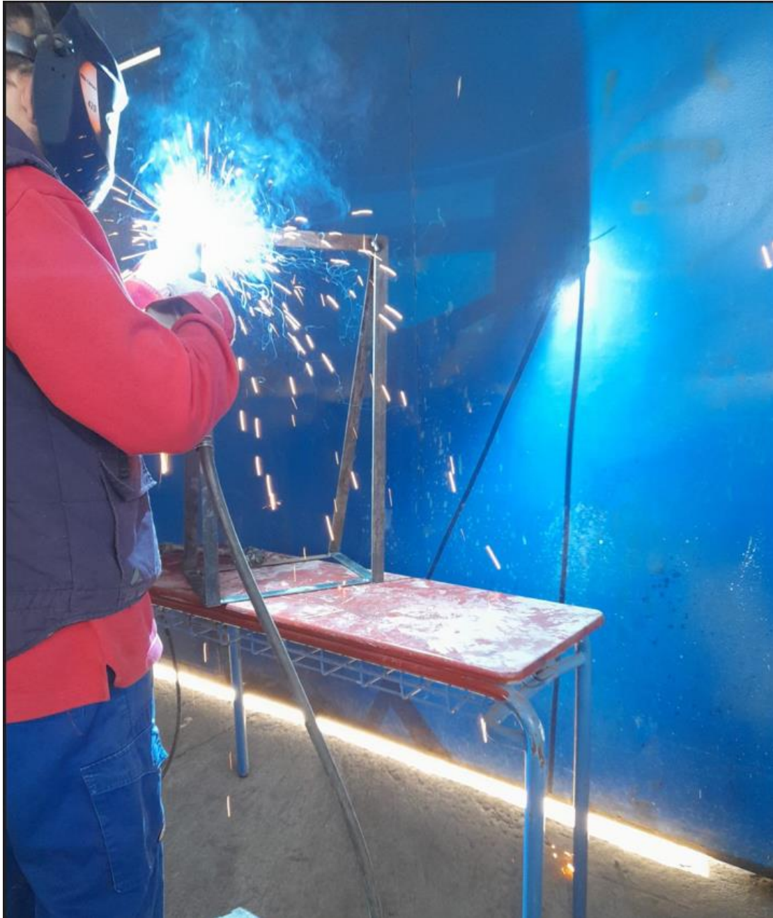
Εικόνα 1 : Συγκόλληση της βάσης του φωτοβολταϊκού πάνελ.
