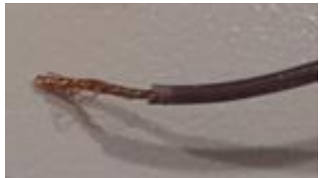
Εικόνα 8: πολύκλωνο καλώδιο 1.5mm X 0,5m χρώματος καφέ.
