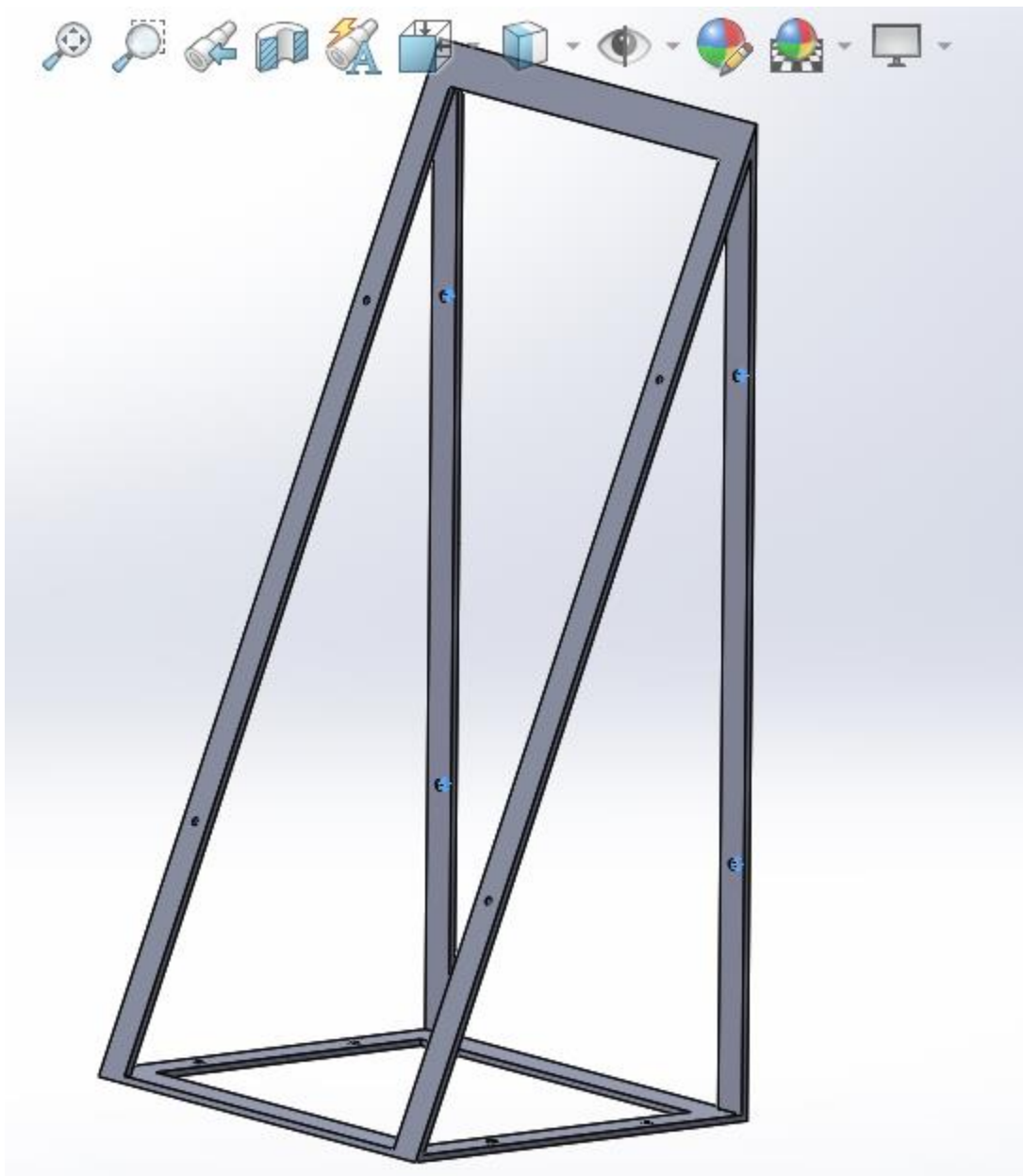
Σχέδιο 3: 3D σχέδιο της βάσης του φωτοβολταϊκού πάνελ στο Solidworks.
