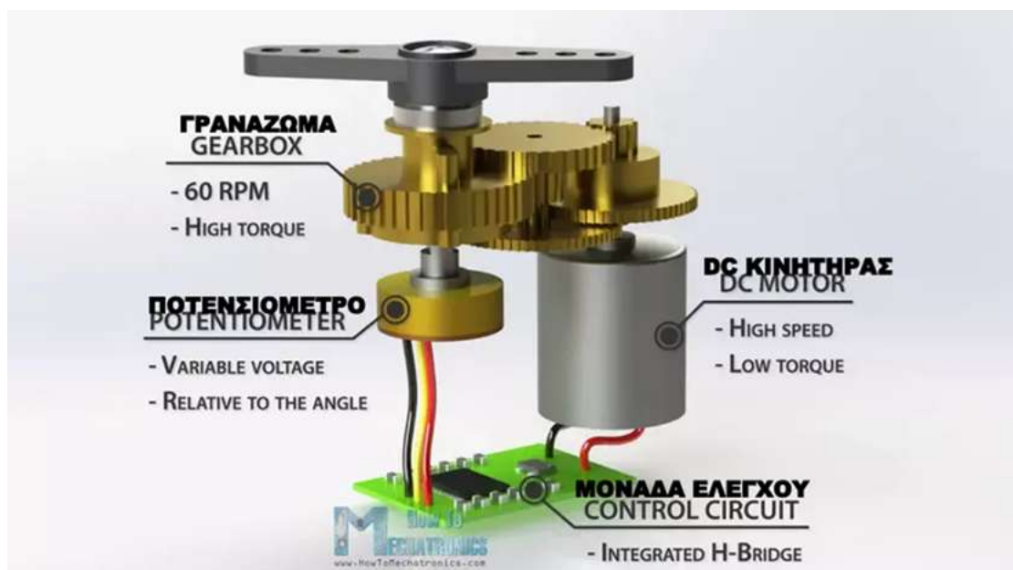
Εικόνα 16: Εσωτερική μορφή Κινητήρα Servo [12]
