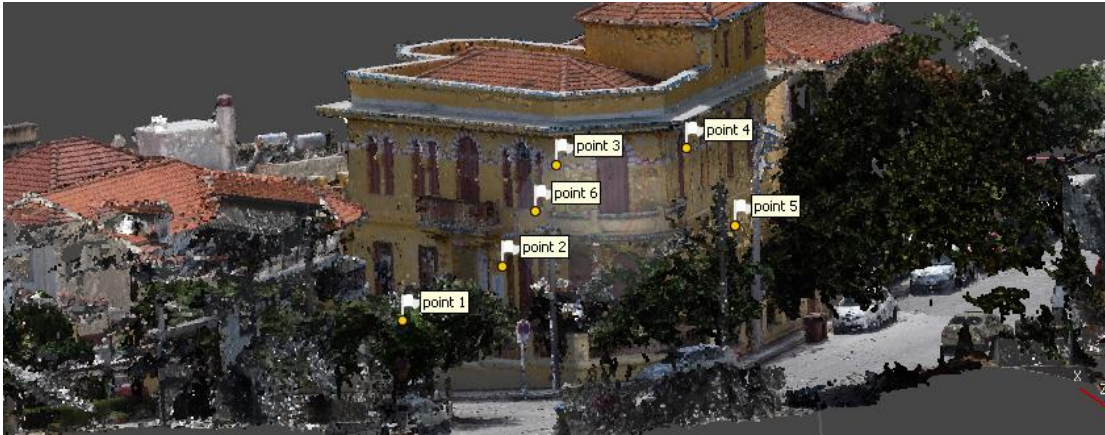
Εικόνα 46: Συνένωση δύο chunk με κοινά σημεία
