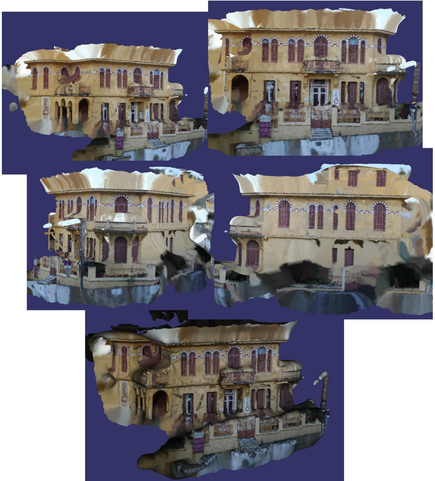
Εικόνα 52: Τελικό αποτέλεσμα απεικόνισης και μοντελοποίησης του 3D κτίσματος της οικίας Σχοινά (σύνθεση από συγγραφέα μέσω Regard3D).
