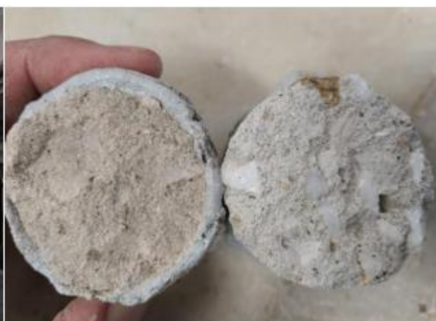
Εικόνα 4.4 Αριστερά δείγμα σκυροδέματος από το τοίχιο T1 που εκτέθηκε σε φωτιά και δεξιά δείγμα από υγιή περιοχή
