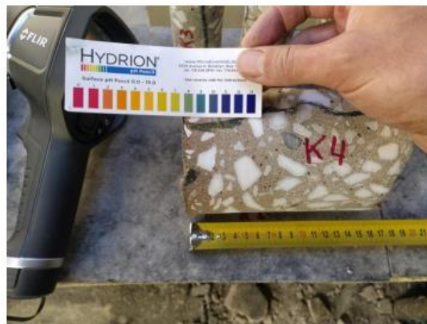
Εικόνα 4.18 Μέτρηση pH με μολύβι ουράνιου τόξου στο T1 . Βάθος ενανθρακωμένου σκυροδέματος με pH κάτω από 9 στα πρώτα 2 cm
