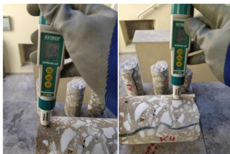
Εικόνα 4.18 Μέτρηση pH με μολύβι ουράνιου τόξου στο T1 . Βάθος ενανθρακωμένου σκυροδέματος με pH κάτω από 9 στα πρώτα 2 cm
