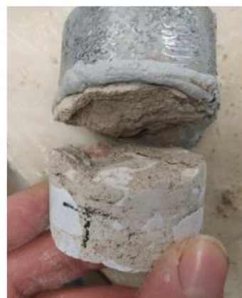
Εικόνα 4.14 Μορφή αστοχίας του T1 της πιλοτής. Φαίνεται το μικρό βάθος στο οποίο συνέβη η αστοχία. Τα αδρανή φαίνεται να έχουν αποκολληθεί από την τσιμεντόπαστα
