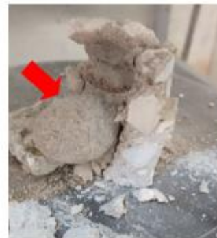
Εικόνα 4.12 Κόκκος αδρανούς στο δοκίμιο K11 που επηρέασε αρνητικά την αντοχή
