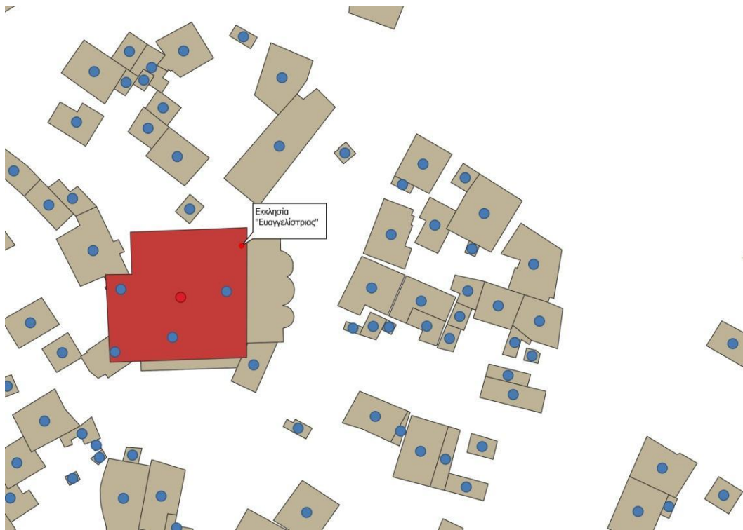
Εικόνα 4.14.(Σχέση 0:1) Ενδεικτικός χάρτης όπου φαίνεται ότι ένα κτίριο στη βάση δεδομένων αναφοράς (Κτηματολόγιο) δεν έχει αντίστοιχο πολύγωνο στο OSM .
