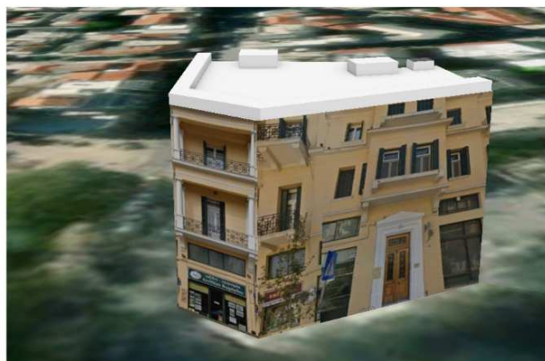
Σχήμα 5.18. Παρουσίαση τρισδιάστατης φωτορεαλιστικής αποτύπωσης της οικίας Παπαβασιλείου κατόπιν επεξεργασίας δεδομένων μέσω ArcGISPro
