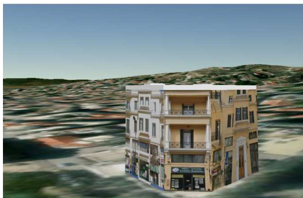
Σχήμα 5.18. Παρουσίαση τρισδιάστατης φωτορεαλιστικής αποτύπωσης της οικίας Παπαβασιλείου κατόπιν επεξεργασίας δεδομένων μέσω ArcGISPro
