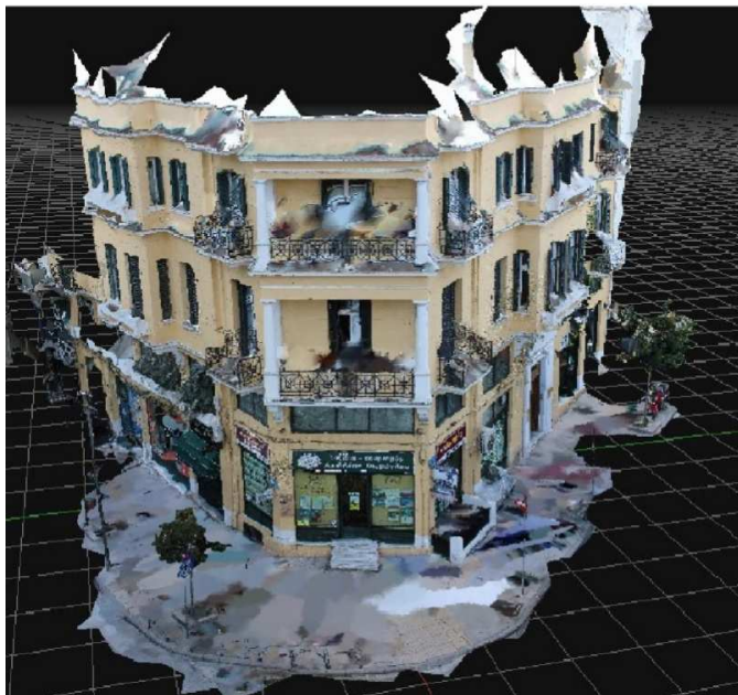
Σχήμα 5.19. Παρουσίαση τρισδιάστατης φωτορεαλιστικής αποτύπωσης της οικίας Παπαβασιλείου κατόπιν επεξεργασίας δεδομένων μέσω 3DF Zephyr).
