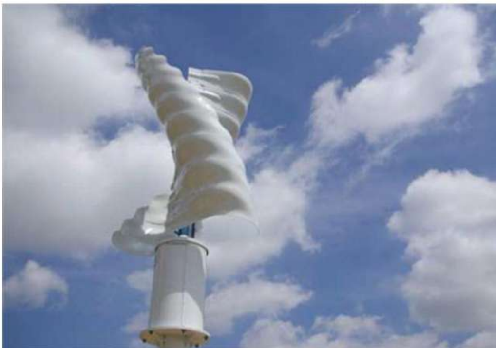
Εικόνα 1-3:Ανεμογεννήτρια Κατακόρυφου Άξονα τύπου Savonius
