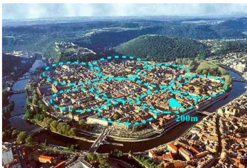
Σχήμα 3.10: Ραδιοκάλυψη πόλης ακτίνας 1 km με σύστημα μετάδοσης στα 868MHz. Η ακτίνα ραδιο-κάλυψης κάθε αναμεταδότη είναι 200m(www.alciom.com).
