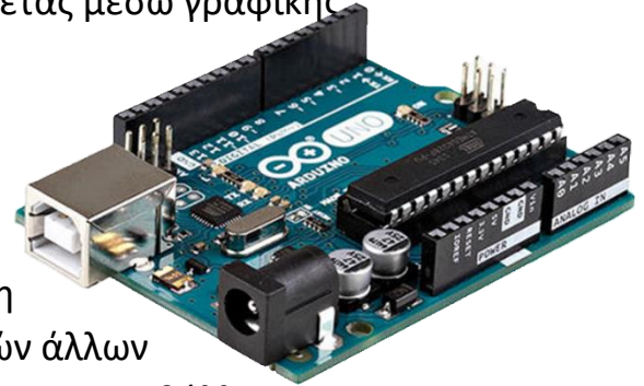
Εικόνα 2.1: Η πλακέτα Arduino UNO που χρησιμοποιήθηκε στο 1 ο όχημα. [Η εικόνα αντλήθηκε από τον ιστότοπο https://www.cleanpng.com/png-arduino-uno-atmega328-single-board-microcontroller-2899186/ ]
