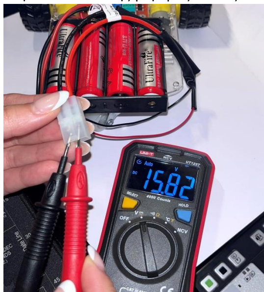
Εικόνα 4.4 Μέτρηση τροφοδοσίας με βολτόμετρο.
