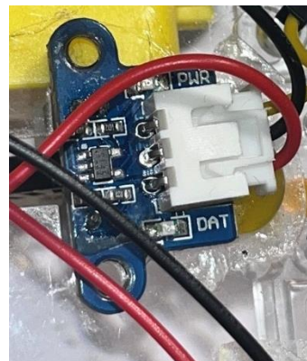
Εικόνα 2.6.2 Το ηλεκτρονικό εξάρτημα του αισθητήρα στροφών.
