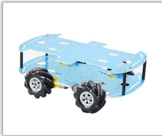
Σχήμα 4.10 – Σασί αλουμινίου και σουηδικοί τροχοί
