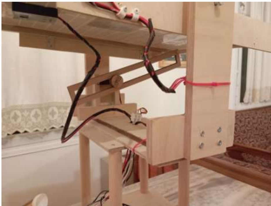
Εικόνα 8 βάση μετάδοσης κίνησης σερβοκινητήρα 2
