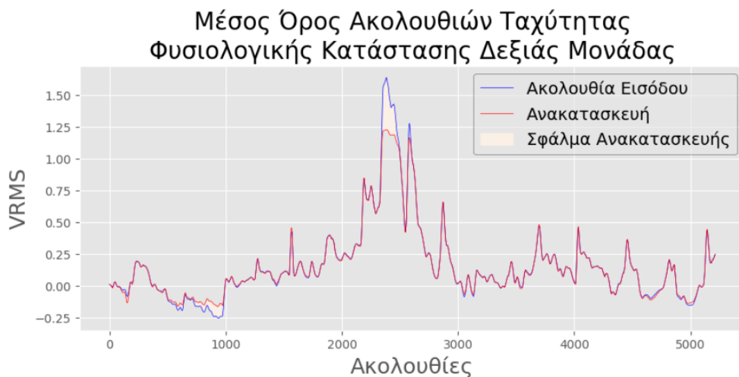
Εικόνα 80. Μέσος Όρος Ακολουθιών Ανακατασκευής Ταχύτητας Φυσιολογικής Κατάστασης Δεξιάς Μονάδας Ρουλεμάν
